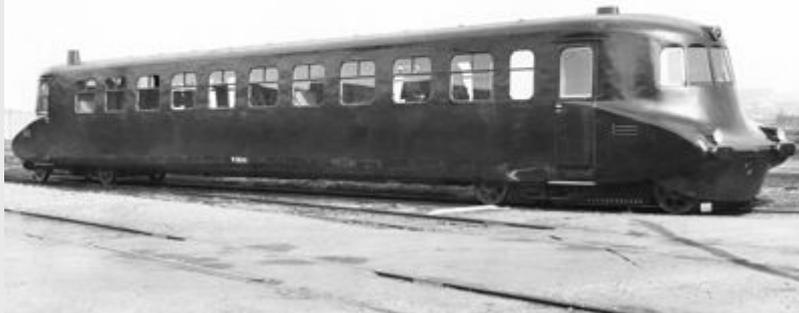
Aber auch Schienenfahrzeugen drückte Ledwinka seinen Stempel auf. 1936 baute der Ingenieur mit am ersten aerodynamischen Schnellzugtriebwagen, dem "Slovenská strela" (Slowakischer Pfeil). Mit einer Höchstgeschwindigkeit von 150 Stundenkilometern war der Zug auf der Strecke Prag-Brno-Bratislava unterwegs.
