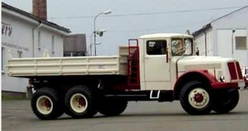
Alle Tatra-Lkw zeichneten sich durch luftgekühlte V-Motoren, Stirnrad-Differentialgetriebe, einen zentralen Rohrrahmen und Allradantrieb aus. Dank der Pendelachsen waren sie sehr geländetauglich. Legitär wurde der dreiachsige Typ 111 mit V-12-Dieselmotor.
