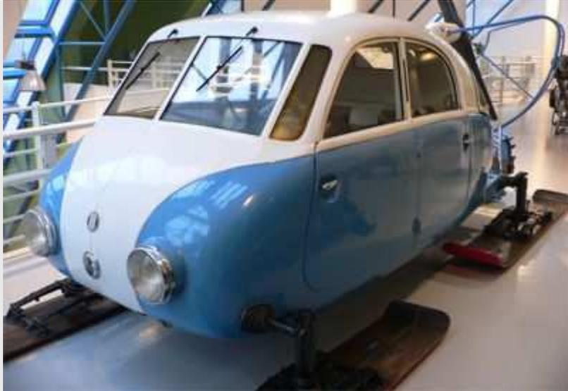
Der Tatra V 855 war der Prototyp eines Motorschlittens auf Basis der Pkw-Typen 87 und 97, den das Tatrawerk in Nesselsdorf 1942 herstellte. Der Schlitten hatte einen luftgekühlten 8-Zylinder-OHC-V-Motor des Pkw-Typs 87 mit 75 PS Leistung. Der hinten eingebaute Motor trieb einen Heckpropeller an. Die Höchstgeschwindigkeit des Fahrzeuges betrug 80 Stundenkilometer.
