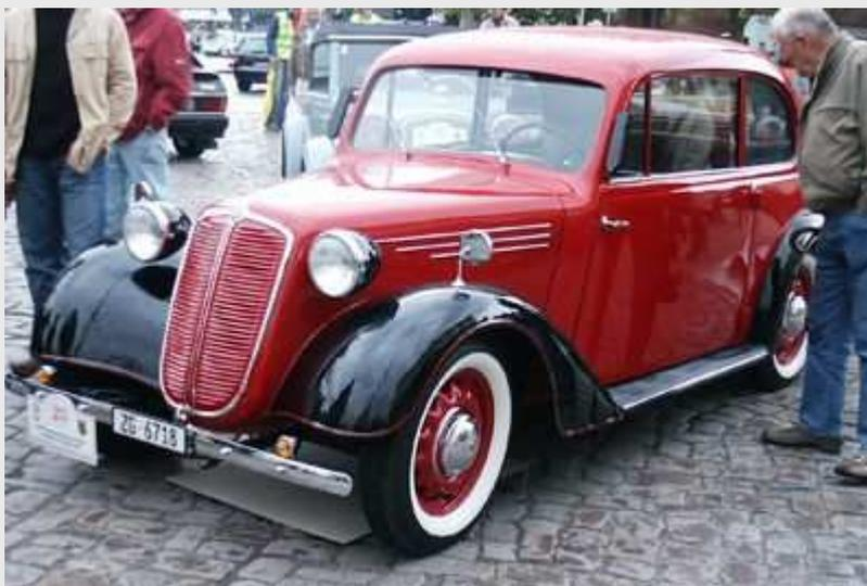
1938 erschien mit dem Tatra 57 B ein weiter verbesserter Nachfolger. Sein Motor hatte 1256 Kubikzentimeter Hubraum und leistete 25 PS. Von dem bis zu 90 Stundenkilometern schnellen Wagen wurde erstmals auch eine Version mit Schiebedach angeboten.
