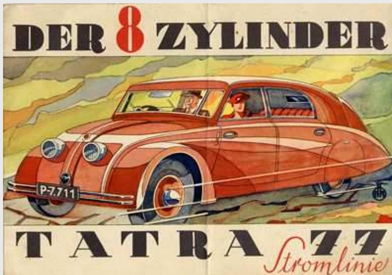
1934 schockierte Ledwinka, inzwischen Direktor des Automobilwerks in Koprivnice, die Fachwelt erneut, mit dem Pkw Tatra 77. Der Wagen war der weltweit erste in Serie hergestellte Wagen mit einer Karosserie nach strengen aerodynamischen Grundsätzen und einem luftgekühlten V8-Motor im Heck.
